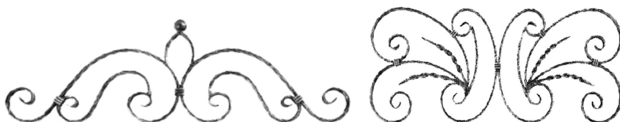
14.005 14.005.01 (amprentat) Bază: 16x6 mm H: 280 mm L: 900 mm
